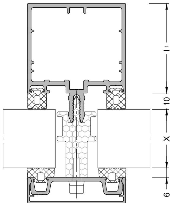
Die im Diagramm dargestellten „Punkte“ sind rechnerisch ermittelte Werte. Der Zuschlag für den Schraubeneinfluss von  $\Delta U = 0,18 \text{ W}/(\text{m}^2\text{K})$  ist in diesen Werten enthalten. (Nachweis Hotbox - Messung)
